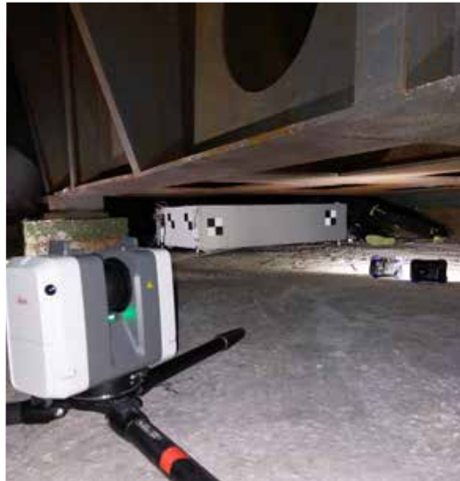
Paldiski tuumareaktori kaardistamine tuumaohutuse firma AS A.L.A.R.A. tellimusele: ülemine on reaktor, selle all poolemeetrises vahes on müüondetektor ning Andres Nurme operaa-tori rollis. Juuni 2023.
