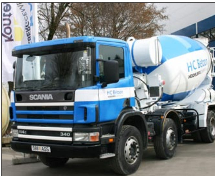
Et betoonisegu ei kahjustuks, peab selle tarne betoonitehasest ehitusplatsile olema ladus. Foto: AS HC Betoon
