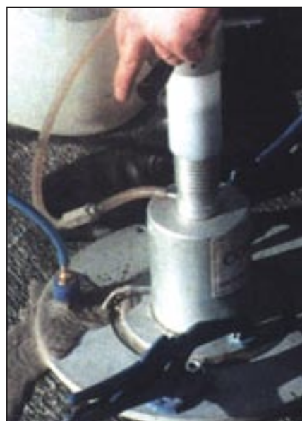
Kärni väljapuurimine seadmega Corecase Standard 75.
