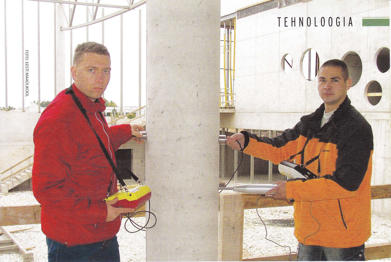
Mihkel Kiviste (ultraheliseadmega) ja Vahur Schmidt (Schmidt'i vasaraga, paremal) EMÜ spordihoone ehitusplatsil.
