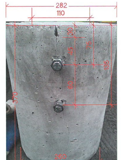
Foto 1. Katsekeha tekitatud pragude ja mõõtudega
